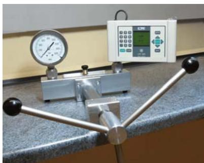
Druckvergleichsprüfeinrichtung LSP 1000-LC
