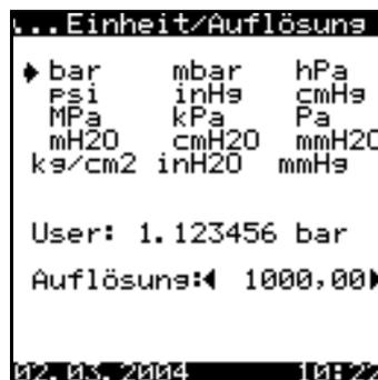
Es kann aus 15 verschiedenen Druckeinheiten ausgewählt werden, darüber hinaus steht eine benutzerdefinierte Einheit "User" zur Verfügung.
