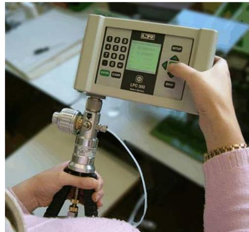
LPC 300 mit Kalibrier-Handtestpumpe LPP 30 im portablen Einsatz
